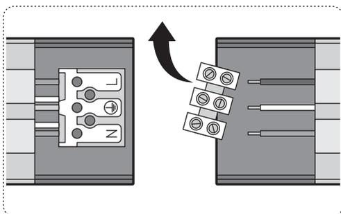
Снять винтовую колодку с магистральных проводов
