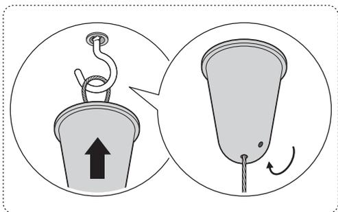
**3** Закрывать шуруп-полукольцо декоративным колпачком, зафиксировав колпачок саморезом
