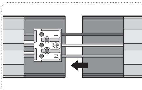
Произвести подключение следующего светильника в линии:
